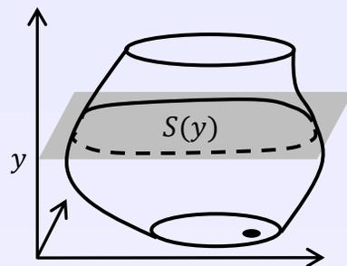
$$\left\{ \begin{array}{l} V = \int_0^y S(t) dt \quad (\text{残りの水の体積は断面積の底から水面までの積分}) \\ \frac{dV}{dx} = -\mu v \quad (\text{体積の減少速度は排水の流速と穴の断面積の積}) \\ \frac{1}{2} v^2 = gy \quad (\text{エネルギー保存則: 「減少する水の位置エネルギー」= 「排出される水の運動エネルギー」}) \end{array} \right.$$
