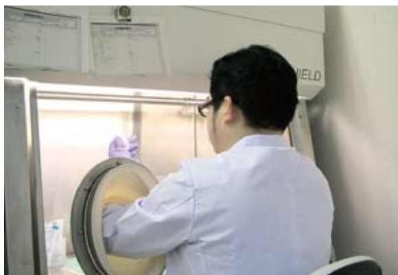
安全キャビネット クラスⅢ 100%完全排気型
