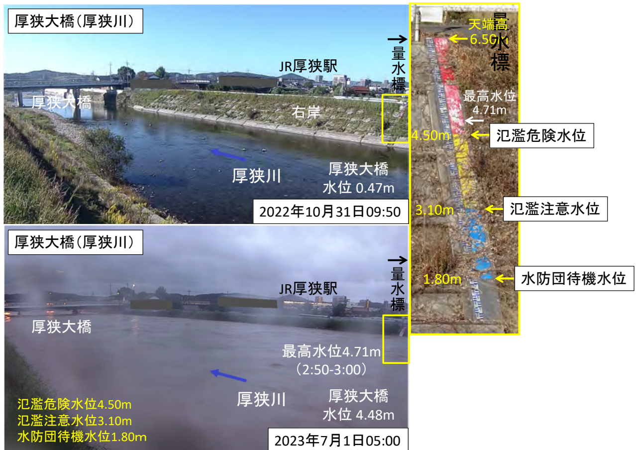
写真4 平常時(2022年10月31日9時50分)と増水時(2023年7月1日5時)における厚狭川厚狭大橋付近の監視カメラ画像(山口県、2023)(筆者らが加筆)および厚狭川右岸に設けられた量水標
