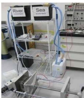
REDシステムの外観 下部にイオン交換膜が挟まったスタックがあり、ここで発電する。
