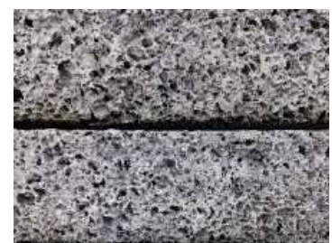
図6-11 軽量気泡ジオポリマー硬化体
