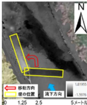
図6-11 円筒状移動堰による堆砂除去(図中黒い範囲が除去された)
