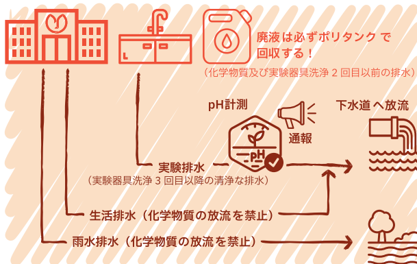
図 3-5 下水道の系統
