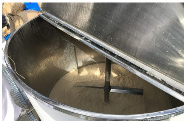
図6-2 発酵試験:焼酎粕投入直後の攪拌の様子
