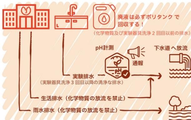
図 3-5 下水道の系統
