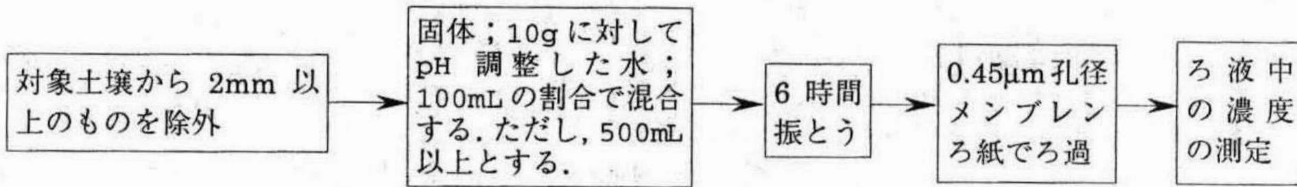
図 4.4-2 環境庁告示 46 号溶出試験（土壌環境基準検定試験）
