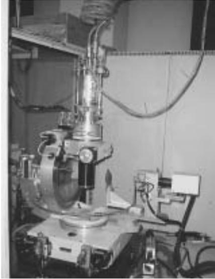
図1 オフセンター型極低温4軸回折装置
