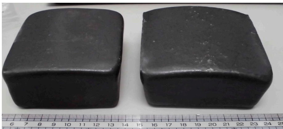
月の模擬レゴリスの焼結固化体 (Sintered monolith using lunar regolith simulant)
