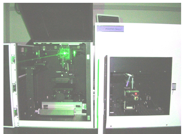
上記ラマンシステムのマクロサンプル室（左：空間分解能100 μm）と顕微サンプル室（右：空間分解能1 μm）。
