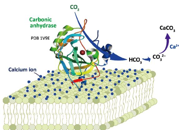
炭酸脱水酵素と脂質膜の機能を利用した二酸化炭素から炭酸カルシウム粒子を生成させる触媒 (Maeshima and Yoshimoto, *Enzyme Microb. Technol.*, 2017)
