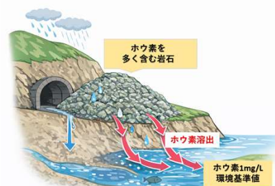
図6-13 建設発生土からのホウ素溶出
