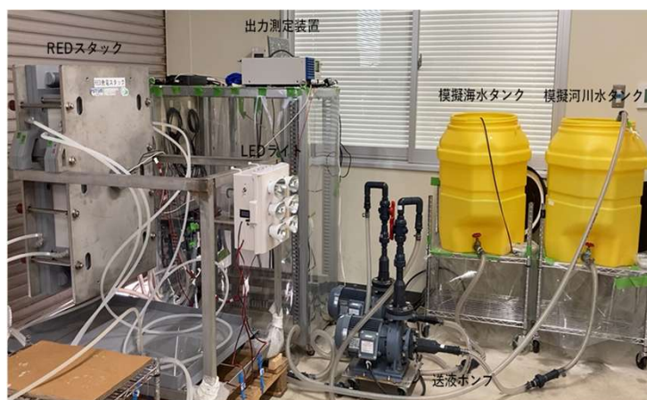
図6-8 RED発電システム
