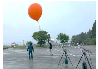
図6-1 粒子撮像ゾンデRainscope放球の様子（熊本県阿蘇にて）
