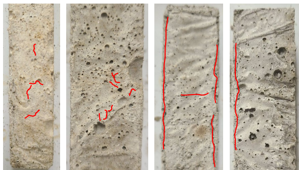
図-11 AN を使用した硬化体の水中浸漬による劣化状況
