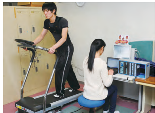
ウェアラブルセンサデバイスを装着することで、いつでもどこでも心肺呼吸情報を計測でき、健康状態をチェックしながら適切な運動を助言できる。
