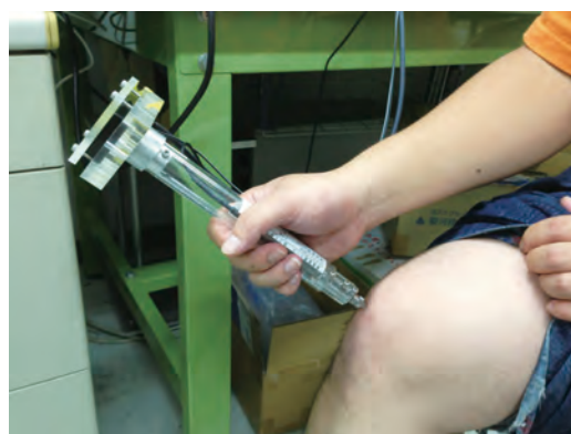
提案する超音波診断装置を用いて膝関節の関節疾患を評価する様子
