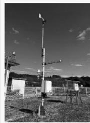
風向風速、温湿度、雨量、日射、日照、気圧、雨滴粒径
