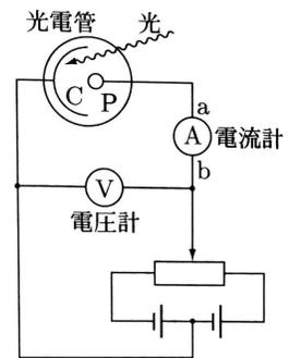
(2) 振動数が同じなのでエネルギーは変わらない。そのため、 $I > 0$  となる電圧は  $-V_0$  のまま変わらない。
